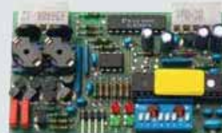
Vyhodnocovač indukční smyčky zásuvná deska 1kanálová nebo 2kanálová, vhodná pro 2 oddělené indukční smyčky, dodávka bez smyčkového kabelu
