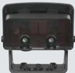
Radarový detektor pohybu MWD-C rychlé a cílené automatické otvírání vrat, rozpoznání směru, max. montážní výška 7 m, montáž v chladírenském prostoru možná do maximálně -22 °C, třída ochrany krytu IP 65
