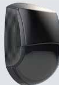
3D laserový snímač Scanprotect monitorování pole pomocí sedmi šikmo nastavených laserových paprsků na principu měření doby průchodu světla, individuální možnosti vyhodnocení, vhodný zejména pro venkovní použití, třída ochrany krytu IP 65
